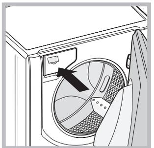
Si trova all'interno della macchina e vi si accede aprendo la porta. Per il dosaggio dei detersivi vedi il capitolo "Detersivi e biancheria".
