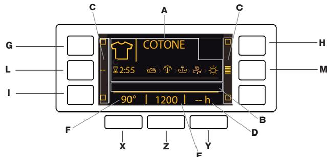
Nell'area **A** vengono visualizzati l'icona e il programma selezionato, le fasi di lavaggio e asciugatura e il tempo residuo alla fine del ciclo. Nell'area **B** vengono visualizzati i due livelli di intensità relativi all'opzione DIRECT INJECTION. Nelle aree **C** sono presenti le spie relative alle funzioni disponibili. Nell'area **D** viene visualizzato il tempo mancante all'avvio del programma selezionato nel caso fosse stato impostato una AVVIO RITARDATO.
