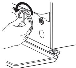
4. Rimuovere il filtro: Disporre un telo di cotone sotto il filtro dell'acqua, in modo che possa assorbire una piccola quantità di acqua residua. Rimuovere quindi il filtro dell'acqua ruotandolo in senso antiorario.
