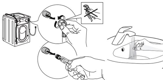
4. Reinserire il filtro a rete. Ricollegare il tubo di carico al rubinetto dell'acqua e alla lavatrice. Non usare utensili per collegare il tubo di carico. Aprire il rubinetto dell'acqua e controllare che tutti i collegamenti siano ben stretti.
