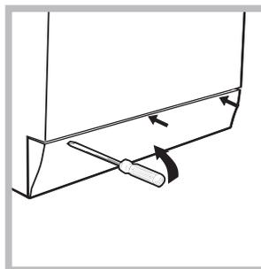
3. rimuovere il pannello di copertura sul lato anteriore della lavabiancheria con l'ausilio di un giravite (vedi figura).
