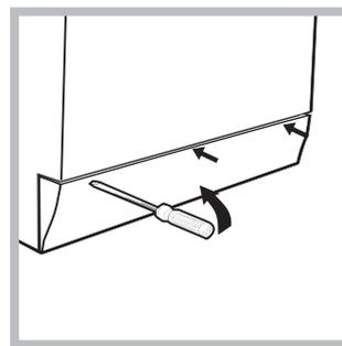
1. rimuovere il pannello di copertura sul lato anteriore della lavasciuga con l'aiuto di un giravite (vedi figura);
